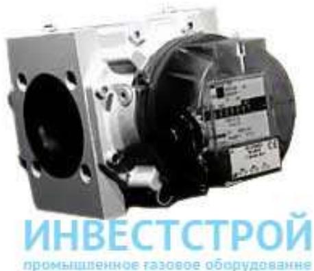
Счетчики типоразмеров от G16 до G650 обеспечивают измерение объемного расхода газа в диапазоне от 1,25 до 1000 м<sup>3</sup>/ч в трубопроводах с диаметрами условного прохода от 40 до 150 мм. Счетчики могут иметь специальное исполнение для учета водорода и кислорода. Для коммерческого учета счетчики DELTA применяются с электронным корректором по температуре UNIFLO или корректором PTZ SEVC-D.
