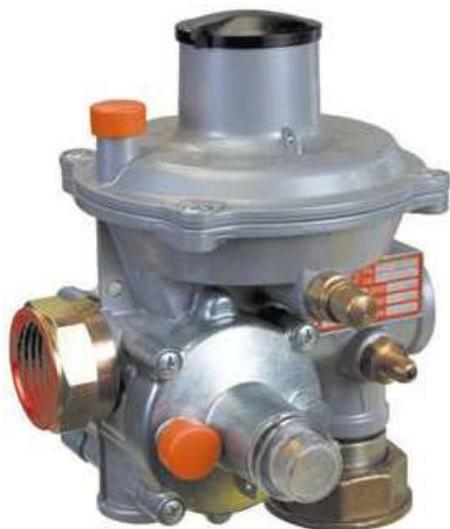
Регуляторы газа FE 10, FE 10L, FE 25, FE 25L предназначены для редуцирования природного газа ГОСТ 5542. Газ, распределяемый при давлении до 0,6 МПа, редуцируется на низкое давление 2 кПа, что дает возможность использования данных регуляторов при газоснабжении коммунально-бытовых объектов.
