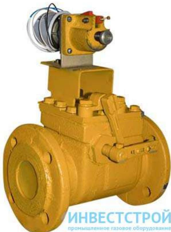
**КПЭГ: КПЭГ-50, КПЭГ-100** — клапаны предохранительные запорные с электромагнитным приводом применяются для прекращения подачи неагрессивных углеводородных газов в системе автоматического управления, использующих газогорелочные устройства.
