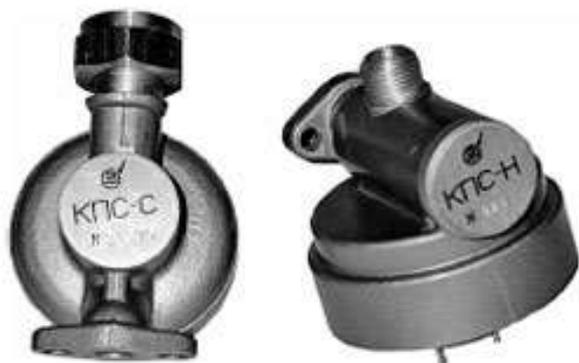
**КПС-Н и КПС-С** — предохранительные сбросные клапаны, применяемые для обеспечения сброса в атмосферу неагрессивных углеводородных газов с расходом не менее 0,5 м<sup>3</sup>/ч при повышении давления в сети сверх заданного значения более чем на 5%.
