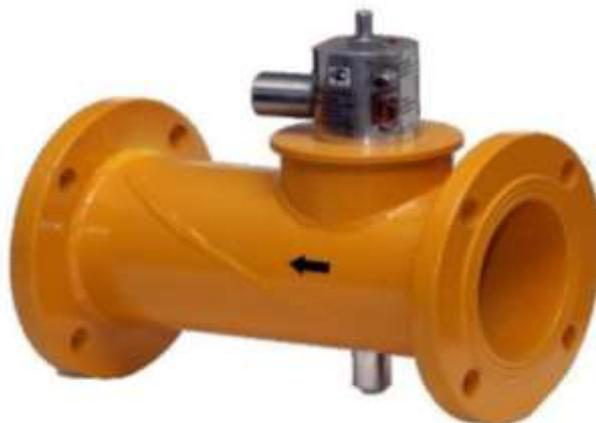
Клапан запорный газовый с электромагнитным приводом КЗГЭМ предназначен для использования в качестве запорного устройства трубопроводных магистралей и газогорелочных устройств с условным проходом 32...150 мм рабочей средой в виде природного газа и рабочим давлением 0,1...300кПа (0,001...3 кгс/см<sup>2</sup>).
