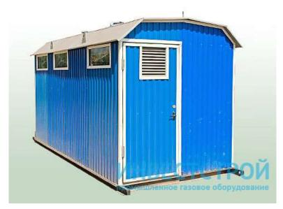
Пункты газорегуляторные блочные (ПГБ) предназначены для редуцирования высокого среднего давления требуемое, автоматического поддержания выходного давления на заданном уровне, независимо от изменений расхода и выходного давления, автоматического отключения подачи газа при аварийном повышении или понижении выходного давления сверх допустимых значений, очистки газа от механических примесей, а также для коммерческого учета расхода газа.
