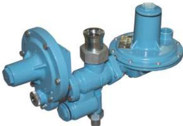
**РДГД, РДГД-20М** — регулятор давления газа комбинированный домовый, обеспечивающий редуцирование среднего и высокого давления на низкое и автоматическое удержание выходного давления на установленном уровне независимо от изменений расхода и входного давления, а также осуществляющий автоматическое отключение подачи газа при аварийных понижении и повышении выходного давления сверх заданных значений.
