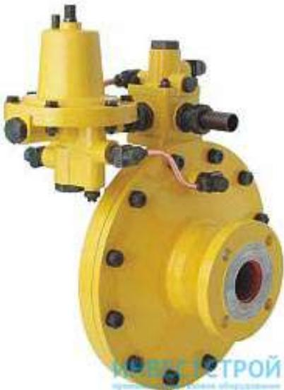
Регулятор давления газа РДП 50Н(В) предназначен для редуцирования давления газа и автоматического поддержания выходного давления в заданных пределах независимо от изменения входного давления и расхода газа и применяется в системах газоснабжения промышленных, сельскохозяйственных и коммунально-бытовых объектов.
