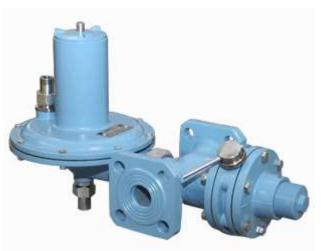
РДУ-32 — регуляторы давления газа универсальные используются для преобразования среднего и высокого давления на низкое и автоматического удержания выходного давления на заданном уровне независимо от изменений расхода и входного давления, а также автоматического отключения подачи газа при повышении выходного давления сверх установленного предела или при уменьшении входного давления ниже определенной величины.
